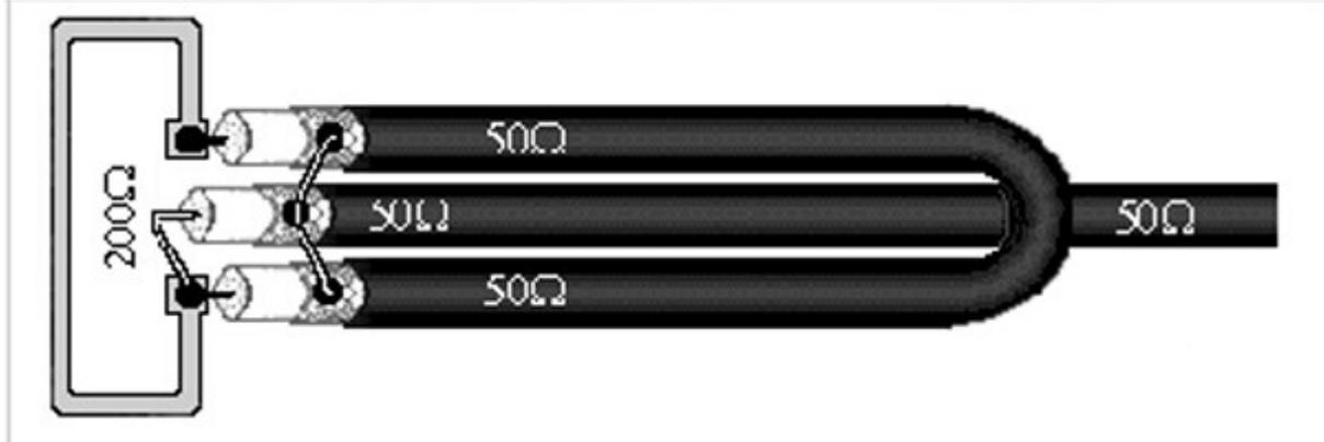
Questo è un **vero BALUN**, **4:1** nel senso che bilancia il carico e contrasta le correnti di modo comune sulla calza. La lunghezza del cavo a “U” è di mezza onda (elettrica) e la sua impedenza è di un quarto del carico che si vuole adattare. Se il dipolo fosse stato da 300 ohm, la “U” avrebbe dovuto essere fatta con cavo da  $300/4$ , ovvero 75 ohm.
